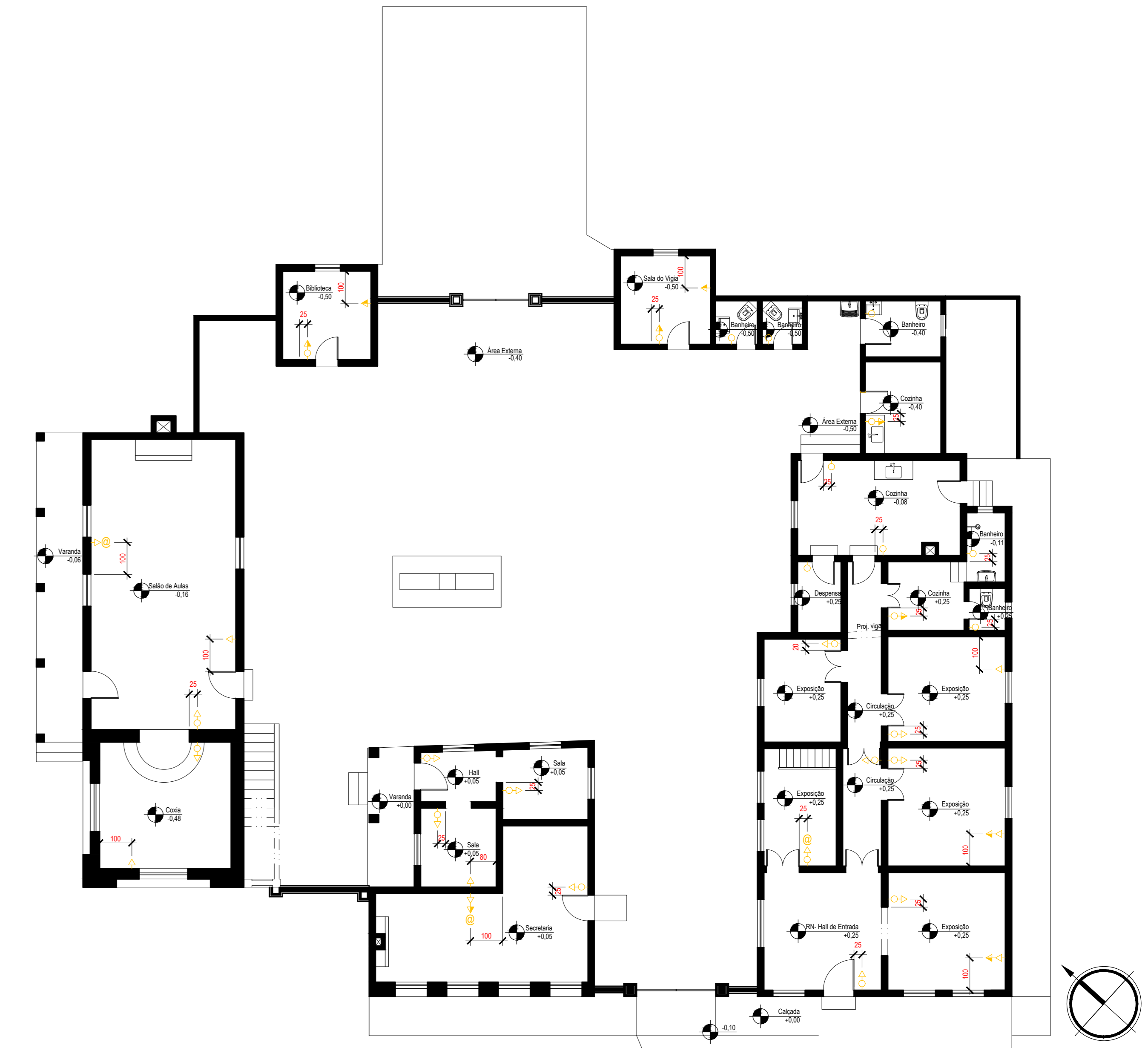
PLANTA BAIXA LANÇAMENTOS PONTOS ELÉTRICOS ESC.: 1/100
